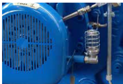
Lubrificador Watchdog montado na linha central do nível de óleo desejado
