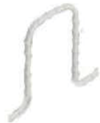
Figura 09 - Vergalhão em formato ômega.
